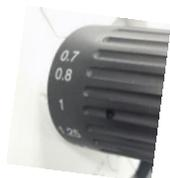
① 対物レンズ(実体顕微鏡ズーム)を測定したいサンプルと同じ状態にします
