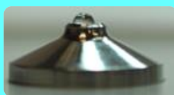
(左図)検出部にサンプルをアプライ (右図)測定時の様子。発光部、受光部の間にサンプルが液柱を形成
